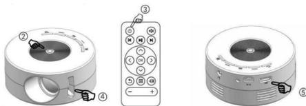
Расположите проектор горизонтально поверхности, объективом к стене или экрану. Включите проектор, отрегулируйте фокус (как на рис. 4) до тех пор, пока изображение не станет четким. Вставьте USB-накопитель в USB-разъем, как показано на рис. 5.
